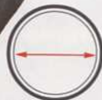
Диаметром линзы называют ее поперечный размер от края до края.
